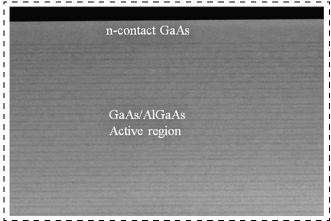
Рис. 2. ПЭМ-изображение активной области многослойной GaAs/AlGaAs-гетероструктуры
