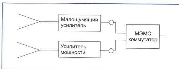
Рис. 2. Схема с индивидуальной встроенной антенной для МШУ и УМ
