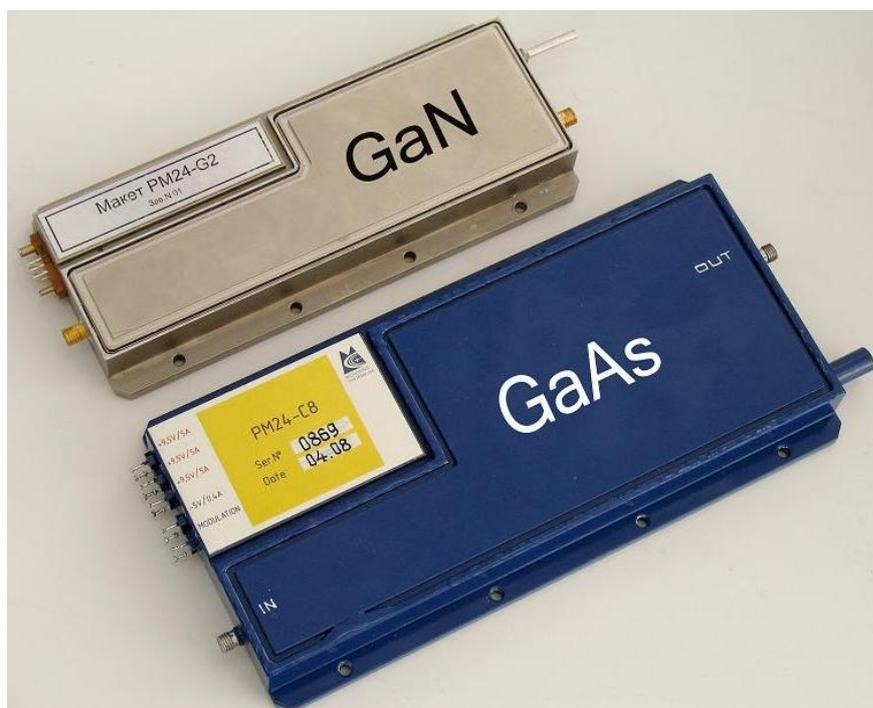
Рис.7. Сравнение габаритов усилителей PM24-C8 (GaAs) и PM24-G2 (GaN)
